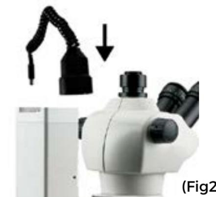
**Nota:** Si es necesario cambiar alguna de las luces LED, recuerde usar el mismo tipo, ya que otras pueden dañar su microscopio.
