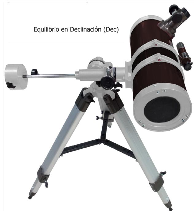
Para un mejor rendimiento del telescopio, nivele la montura ecuatorial, puede ayudarse de cualquier nivelador de burbuja o con la App "Precise Level gratuito" Un tripié nivelado permite ajustes finos más fáciles y mejor distribución del peso. Ajuste la altura de cada pata del tripié hasta que quede centrado.
