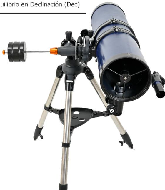
Para un mejor rendimiento del telescopio, nivele la montura ecuatorial, puede ayudarse de cualquier nivelador de burbuja o con la App "Precise Level gratuito" Un tripié nivelado permite ajustes finos más fáciles y mejor distribución del peso. Ajuste la altura de cada pata del tripié hasta que quede centrado. \*Nótese que las patas del tripié no tiene porqué estar a la misma altura si la montura está perfectamente nivelada.
